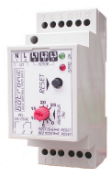
KUČIŠTE RK35: Dimenzije: 35x90x71 Montaža: na šinu 35mm Materijal: samogasivi NORIL Boja: bela Stepen zaštite: IP40/IP60 Broj priključaka: 6+6
